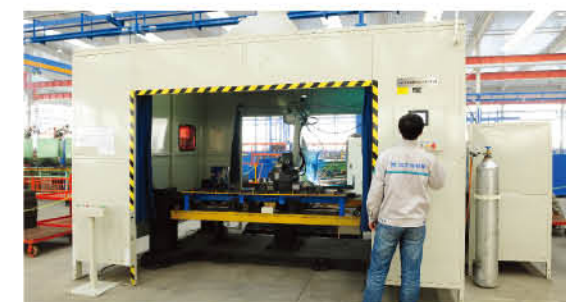
Японское оборудование автоматизированной сварки
