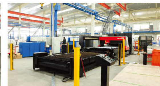
Японское оборудование лазерной резки AMADA FO-3015
