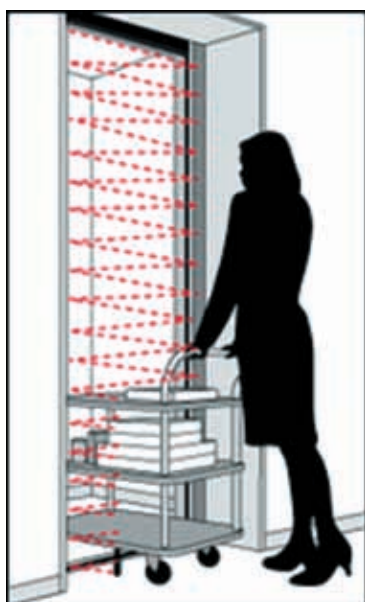
■ В совокупности с устройством механического реверса дверей используется инфракрасная световая завеса, позволяющая полностью контролировать проем дверей
