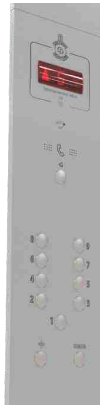
Табло VEGA TTF 5.7" - цветной ЖКИ с вариантами голосового информирования по желанию заказчика. Отображает текущее время, дату, грузоподъемность, номер этажа, направление движения, сообщение о перегрузке, также возможно устанавливать в качестве фона различные изображения на каждый этаж.
