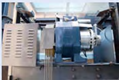
Синхронный двигатель с постоянным магнитом - наиболее современная технология
