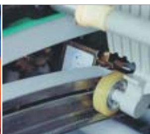
❶ Блокировка бегунков ступеней эскалатора
