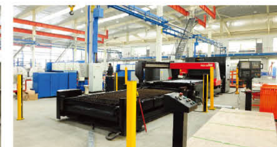
Японское оборудование лазерной резки AMADA FO-3015
